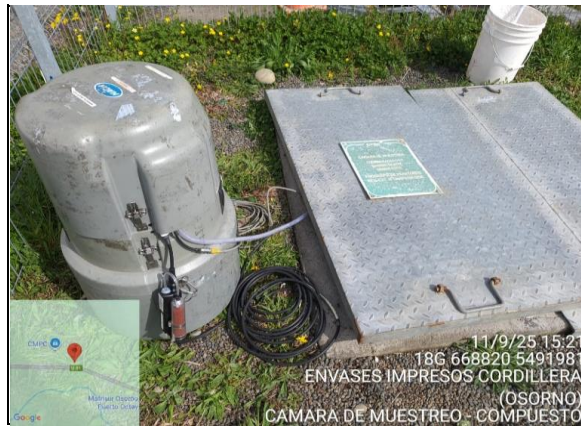
Fotografía 3: Punto de monitoreo y Equipo Automático Instalado
